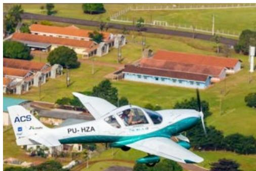
y media, con velocidad crucero de 190 km/h y velocidad máxima de 340 km/h. Tiene 8 m de envergadura y peso total de 650 kg;
